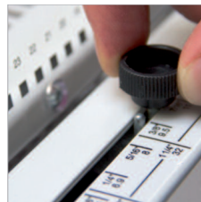
Curseur permettant d'ajuster le système de sertissage au diamètre de l'élément de reliure utilisé.
