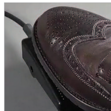
Déclenchement électrique de la perforation par pédale pour une productivité accrue.
