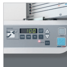
Panneau de commande avec affichage du compteur / décompteur sur écran LCD.
