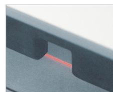
Matérialisation de la ligne de coupe par LEDs.
