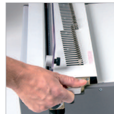
Les outils de perforation ainsi que les modules de reliure «MBS» peuvent se changer très rapidement et facilement.
