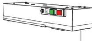
Conduit d'air en acier galvanisé avec grille de sécurité pour la distribution de l'air chaud à l'intérieur du vestiaire. Il sert aussi de bac afin de récupérer les gouttes d'eau tombant des bottes et vêtements (il ne s'agit pas d'un bac de rétention).
