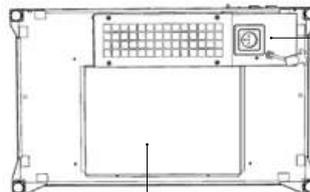
Le **bloc moteur**, fixé en dessous du socle, peut être facilement démonté à l'aide des 4 vis en cas de maintenance sans déplacer, ni basculer le vestiaire.
