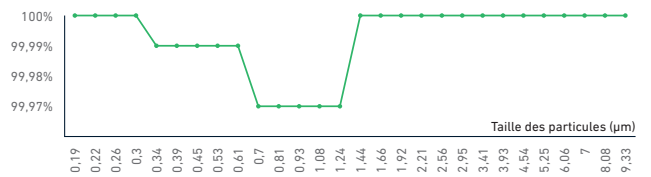
Media filtrant TFH 91-03 : Performance de filtration mesurée à 124 m 3 / h selon norme DIN 71460-1 (granulométrie fine AC 0,19 – 9,33 µm)
